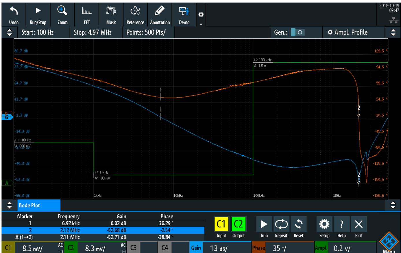
使用者可以在測量過程中改變產生器訊號的振幅輸出位準，以抑制 DUT 的雜訊特點
